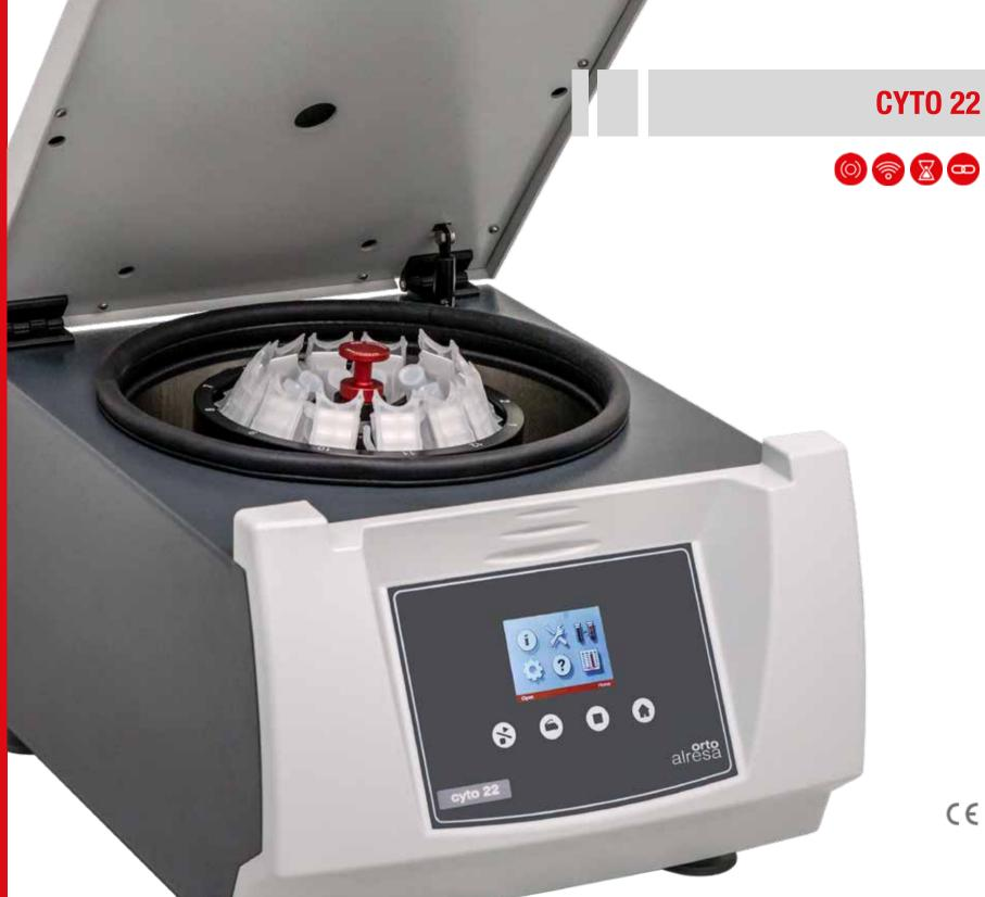
Nuestra citocentrífuga está diseñada para la concentración de muestras biológicas sobre una superficie visible al microscopio, y su posterior identificación y caracterización. Sus accesorios, provistos con el sistema REI (Rotor Easy to Install), se instalan en el rotor de forma segura sin necesidad de herramientas, y se desbloquean con solo retirarlos de su posición.
